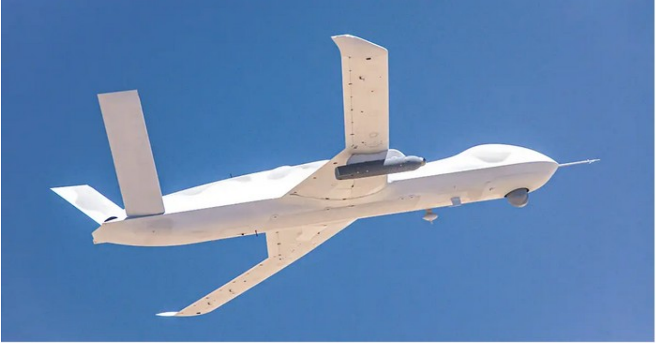
GA-ASI A General Atomics Avenger with a Lockheed Martin Legion Pod containing an IRST system under its right wing. Sağ kanadının altında bir IRST sistemi içeren Lockheed Martin Legion Pod'lu General Atomics Avenger.
